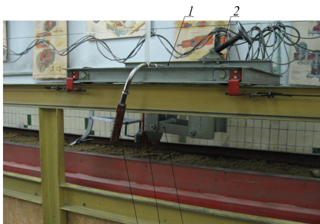
1 – візок; 2 – гвинт регулювання глибини ходу; 3 – паралелограмна навіска; 4 – вертикальний кронштейн; 5 – пульт керування
