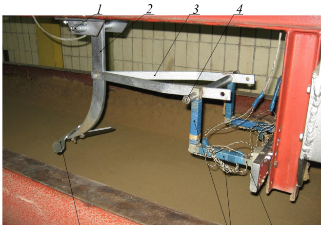
1 – вісь; 2 – стійка; 3 – тяга; 4 – вісь; 5 – Г-подібні кронштейни; 6 – тензометричні датчики; 7 – лапа
